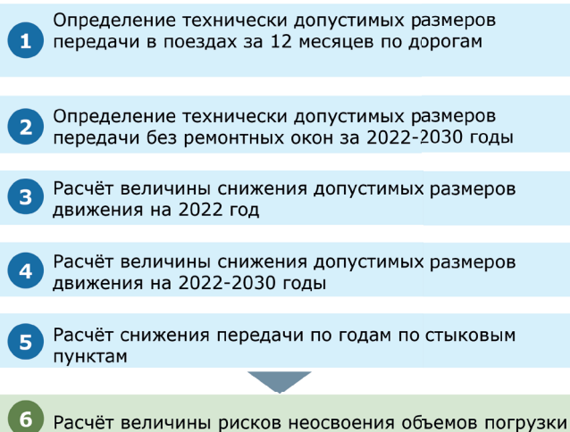
Рисунок 2. Технология расчёта рисков неосвоения перевозок по вариантам организации проведения ремонтно-путевой кампании (на долгосрочный период)
