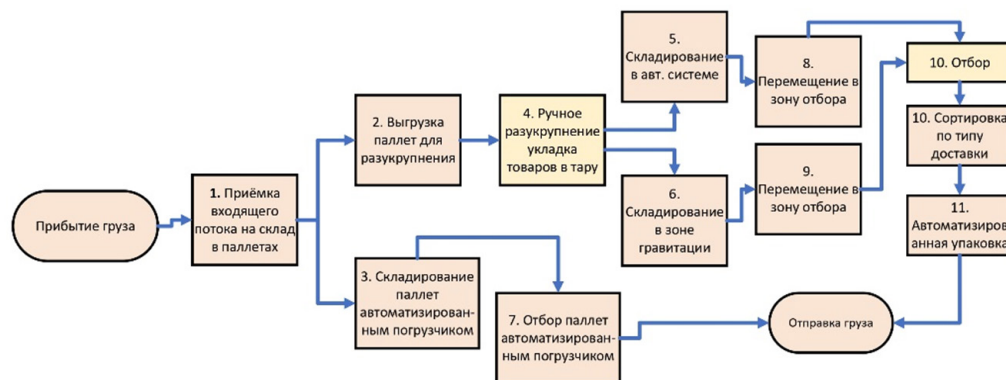
Рисунок 2. Укрупнённая технологическая схема работы ТСК
