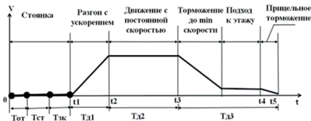
Рисунок 2. Зависимость скорости движения кабины лифта от команд системы управления
